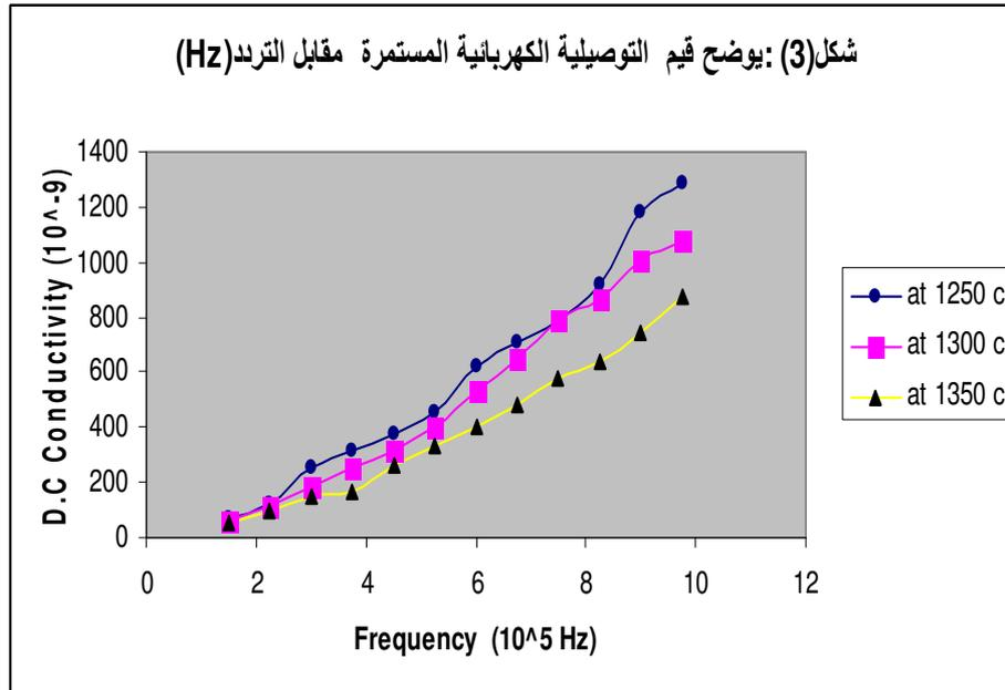
شكل رقم (3): يوضح العلاقة بين قيم التوصيلية الكهربائية المستمرة مقابل قيم التردد (Hz) للمجموعة (X3) المحروقة بدرجات (1250°C , 1300°C, 1350°C).
