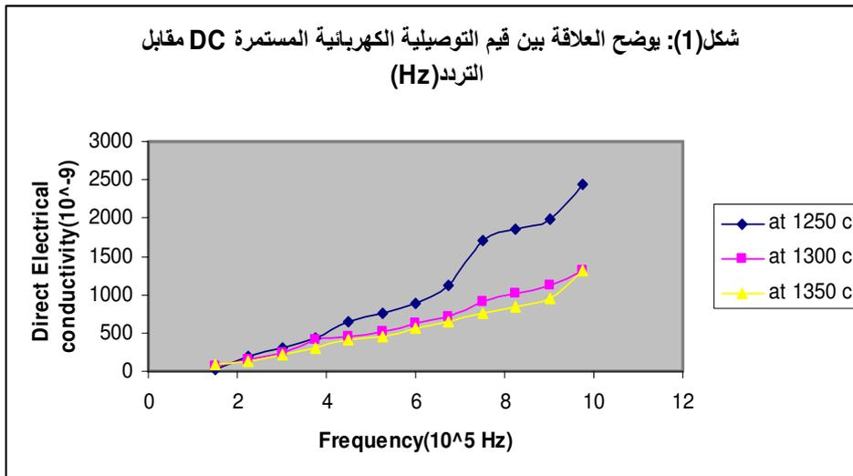
شكل رقم (1): يوضح العلاقة بين قيم التوصيلية الكهربائية المستمرة مقابل قيم التردد (Hz) للمجموعة (X1) المحروقة بدرجات
