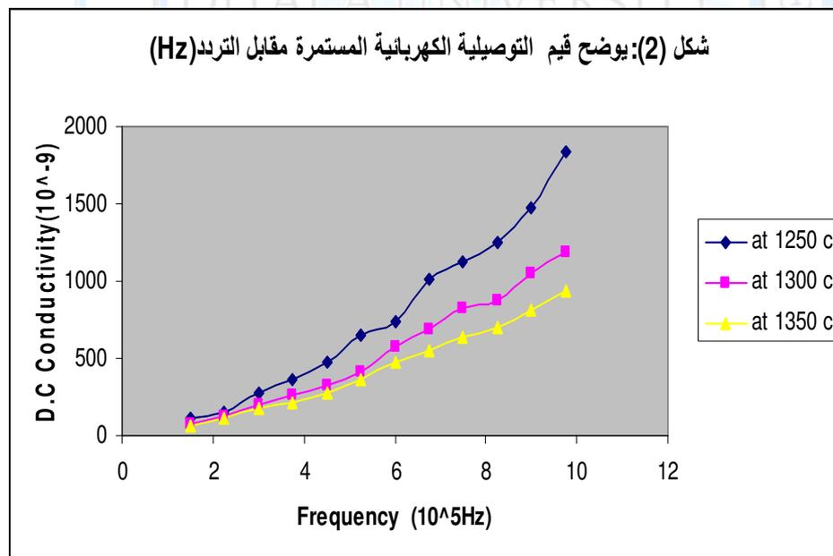
شكل رقم (2): يوضح العلاقة بين قيم التوصيلية الكهربائية المستمرة مقابل قيم التردد (Hz) للمجموعة (X2) المحروقة بدرجات
