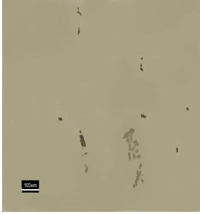
b- الشبكة المنتجة بدون استخدام مساعد صهر (W)
