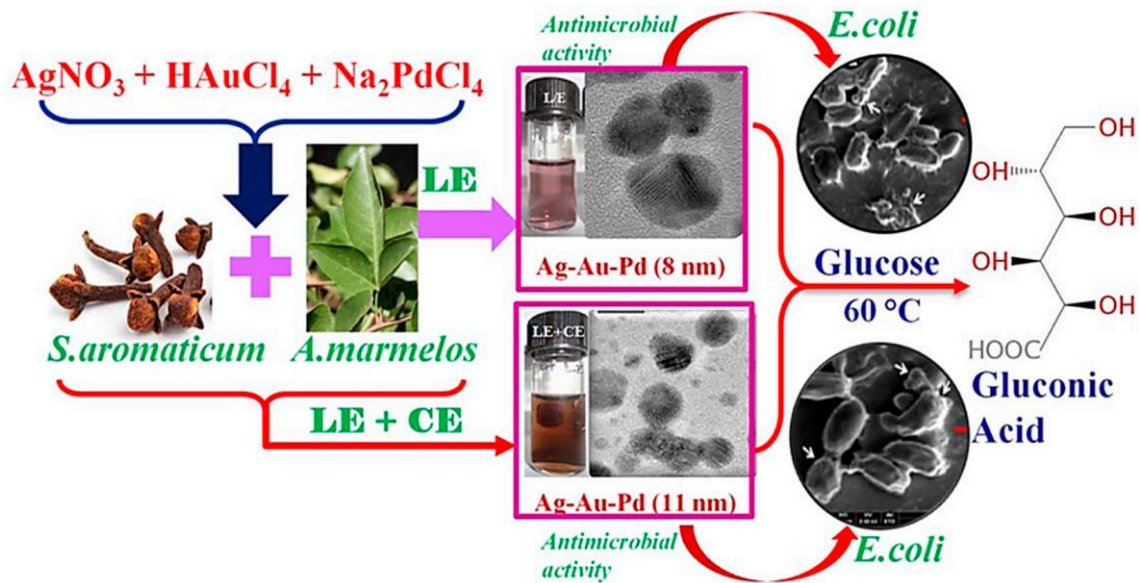
الشكل 15.1 رسم تخطيطي لتصنيع مترابكات نانوية ثلاثية الفلزات ونشاطاتها التحفيزية في أكسدة الجلوكوز و/أو التطبيقات المضادة للميكروبات (Nasrollahzadeh et al., 2020).
