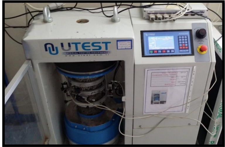
شكل (4) فحص معامل المرونة الساكن
