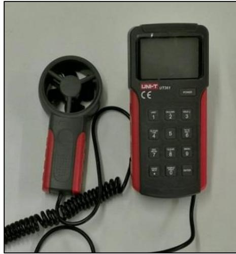
الشكل (4) يوضح جهاز مقياس السرعة الخطية للهواء داخل النفق الهوائي.
