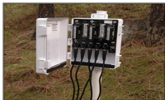
شكل 1. المتحسس GS3 ومسجل البيانات Data logger.
