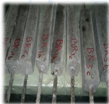
شكل ( 2 ) يوضح النماذج الخرسانية المسلحة المستخدمة
